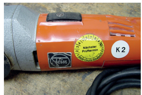
Werden an einem Arbeitsplatz Betriebsmittel unterschiedlicher Schutzkategorien benutzt, ist eine deutliche Kennzeichnung, z. B. mit Aufklebern, sinnvoll und hilfreich
