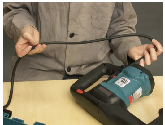
Für eine kurze Sichtprüfung vor Arbeitsbeginn sind die Beschäftigten selbst verantwortlich
