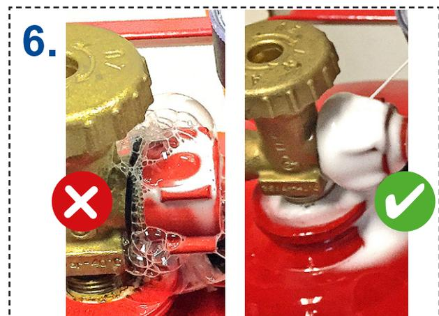
Am Schluss immer prüfen, ob der Anschluss dicht ist – der aufgesprühte Schaum darf keine Blasen werfen
