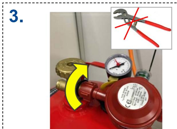
Jetzt mit der Hand Druckregleinrichtung abschrauben – rechtsherum drehen, keine Zange benutzen
