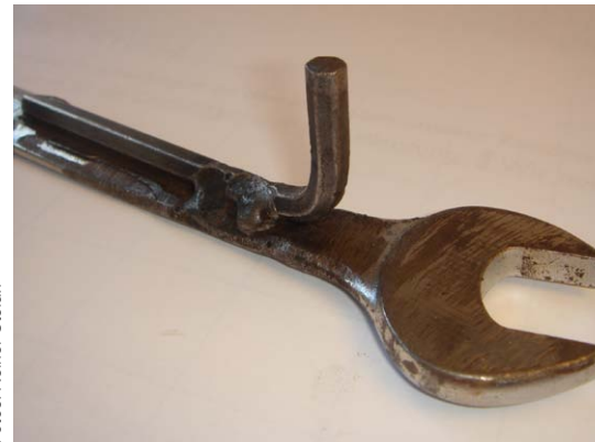
Unzulässig: Selbst aufgeschweißter Inbus-Schlüssel
