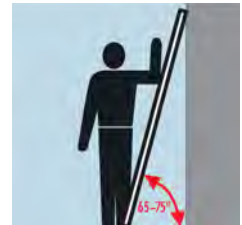
Die „Ellenbogenmethode“ zur Prüfung des Anstellwinkels
