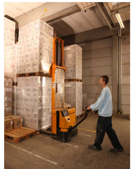
Wichtig: Für die bestmögliche Lage des Lastschwerpunkts bei der Aufnahme von Paletten die Gabel des Hubwagens immer so weit wie möglich in die Palette hineinfahren.
