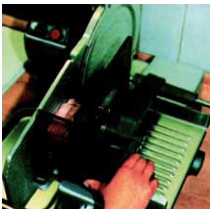
Abb. 8: Das zu schneidende Reststück wird zwischen Resthalter und Anschlagplatte eingeklemmt und dem Messer zugeführt
